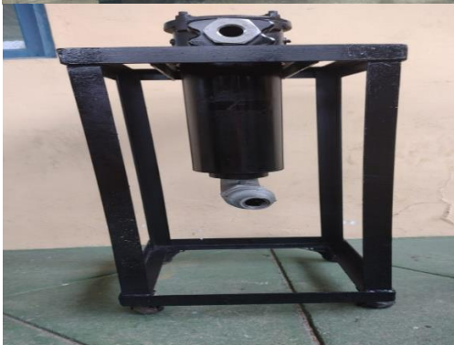
Skid de Filtragem
