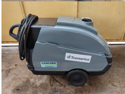
Lavadora Alta Pressão - Caldeira Vapor
